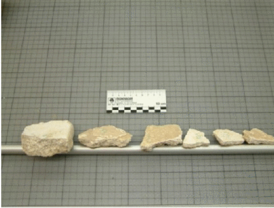
شكل رقم (13) قطع من انتلايس الجيرية المستخدمة في تريم. ويتضح من الصورة السماكات المختلفة لها بحسب العناصر البنائية الملمسة (الباحث)
